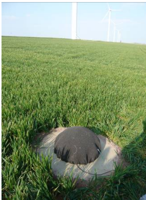
Figure 56 : point de mesure de la puissance acoustique apparente de l'éolienne (point A_{eol} ) avec sa protection anti-vent
